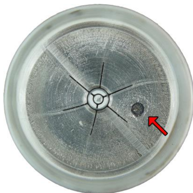
Rys. 6. Wnętrze uszkodzonego tyrystora pastylkowego. Strzałką zaznaczono miejsce uszkodzenia powstałego na skutek przegrzania wynikającego ze zbyt dużego prądu
